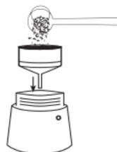
3. Setzen Sie den Trichter wieder ein. Füllen Sie diesen mit nicht zu fein gemahlenem Espresso-Pulver. Das Pulver nicht fest anpressen, nur glattstreichen! Säubern Sie den Rand des Gewindes von überschüssigem Espresso-Pulver.
