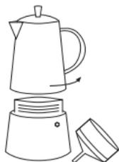
1. Draai de espressokoker uit elkaar door het onderste gedeelte vast te houden en het bovenste gedeelte tegen de klok in eraf te draaien. Haal de trechter eruit.
