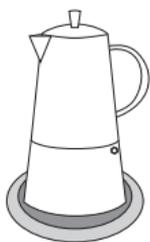
5. Zet de espressokoker op een geschikte warmtebron en verhit de koker alleen op de middelste stand om overkoken te voorkomen en de koker te ontzien. De espresso stijgt onder lichte dampontwikkeling in het bovenste deel. Verwijder de koker direct van de warmtebron, zodra u een zacht borrelen kunt horen. **Aanwijzing:** Er kan een kleine hoeveelheid water in het onderste deel van de koker achterblijven.
