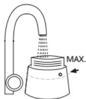
2. Llene con agua la parte inferior de la cafetera italiana hasta, como máximo, un poco por debajo de la válvula de seguridad. ¡Atención! La válvula de seguridad no debe quedar por debajo del agua.
