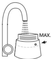
2. Remplissez la partie inférieure de la cafetière expresso avec de l'eau jusqu'à juste en dessous de la soupape de sécurité au maximum. **Attention !** La soupape de sécurité ne doit pas se trouver sous l'eau.
