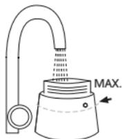
2. Füllen Sie Wasser in das Unterteil des Espresso-Kochers bis maximal kurz unter das Sicherheitsventil. **Achtung!** Das Sicherheitsventil darf nicht unter Wasser liegen.
