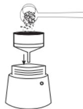
3. Vuelva a colocar el embudo. Llénelo con café espresso en polvo no demasiado molido. ¡No presionar el polvo demasiado, solo alisarlo! Limpie el borde de la rosca del exceso de café espresso en polvo.
